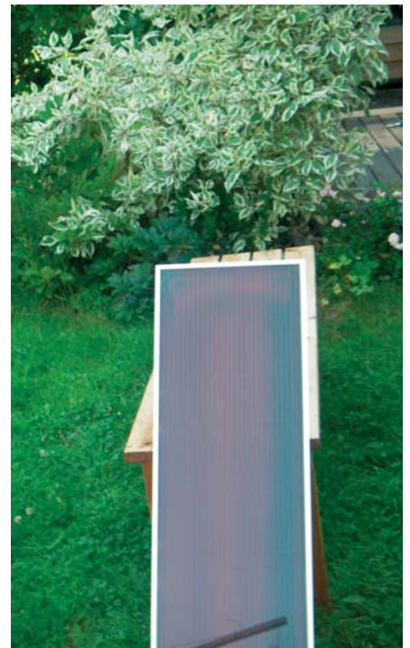
Solcellmodul av sammankopplade kiselplattor 30 cm x 90 cm.
