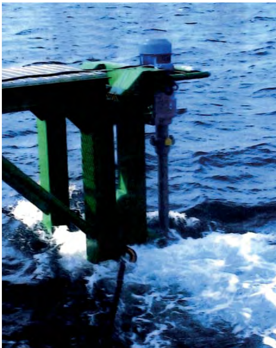
Strömturbin under testkörning som tidvattenturbin på Shetland.
