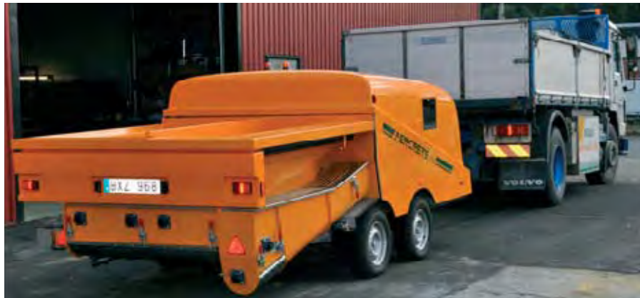
Gasilage AB:s skumbetongblandare Aercrete 625 redo med biogas i tanken på lastbilen. Foto: A Fjortoft 2009
