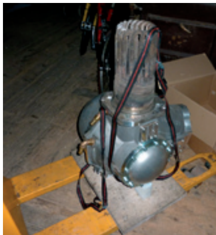
Stirlingmotorn från Sonnemaschine drivs med pellets och genererar 3 kW el och 10 kW värme.
