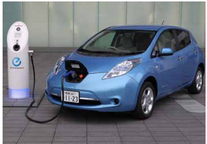
Nissa Leaf finns att köpa i Sverige och behöver 1,5 kWh per mil och har en räckvidd på mellan 20 och 30 mil. Bild: Nissan.
