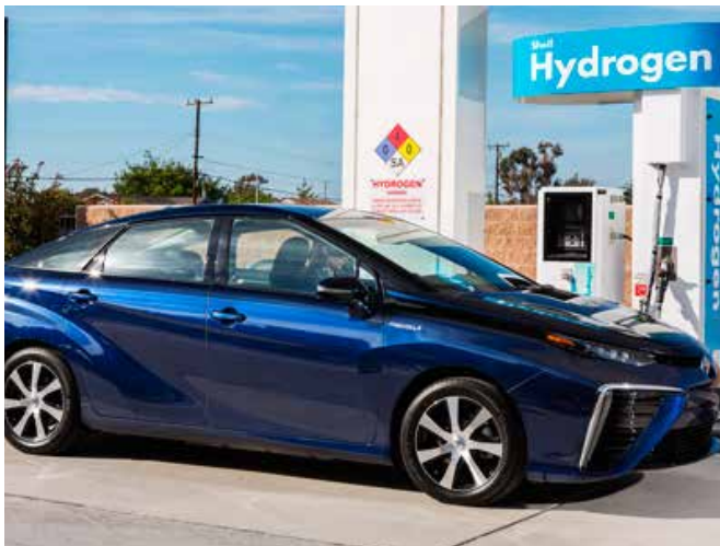
I Japan finns den kommersiell bränslecellsdrivna bilen Toyota Mirai som har en räckvidd på 40 mil och behöver en kubikmeter vätgas per mil. Bild: Toyota.
