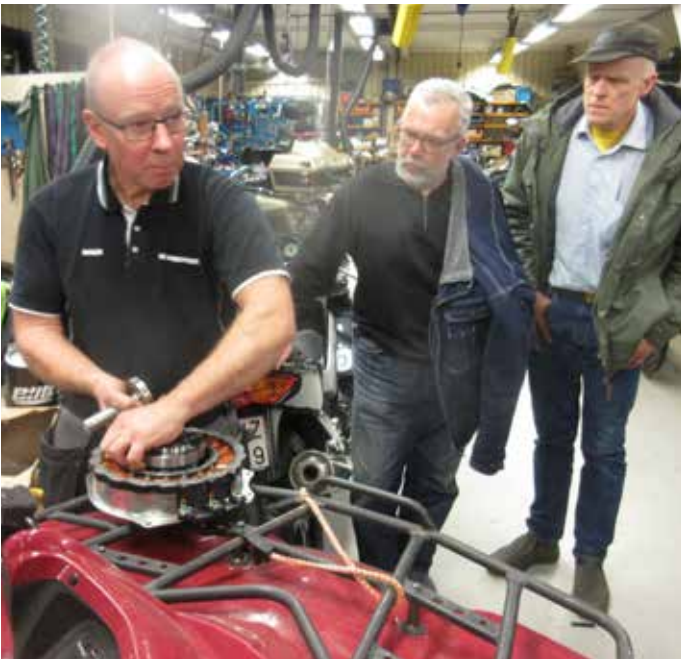
Bosse Abrahamsson visar hur man monterar in en elmotor i en konventionell bil.
